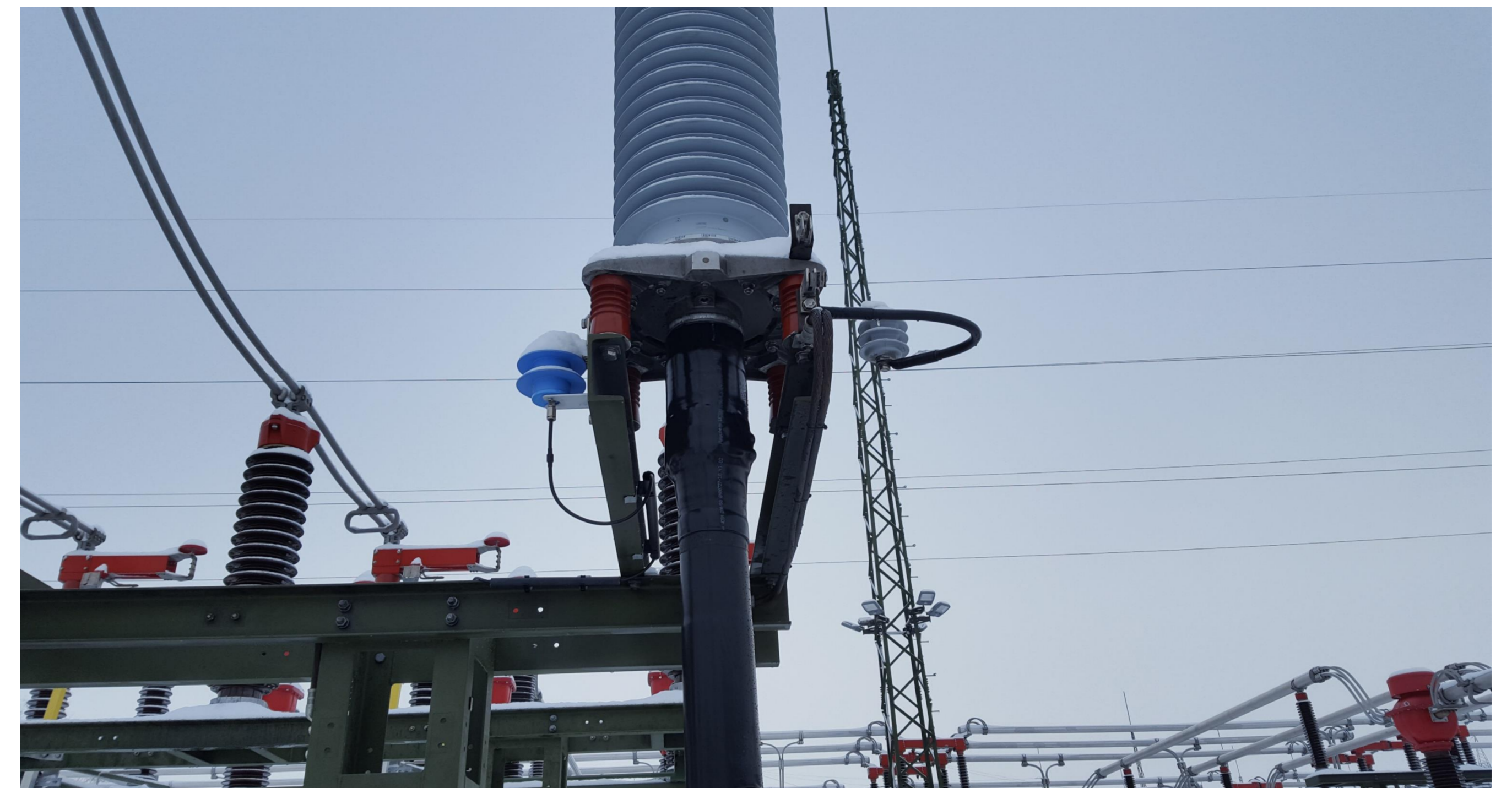
Diagnóstico UHF DP realizado en terminación de AT usando un sensor UHF capacitivo.
