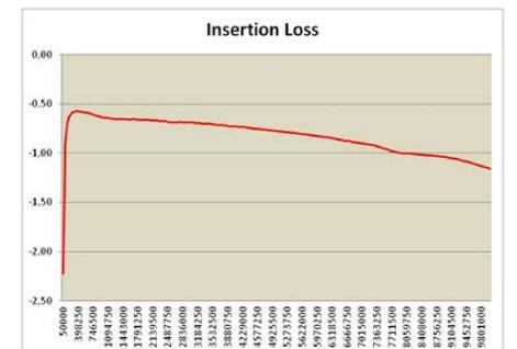
La conexión se realizará mediante un acoplador basado en el CAMS-10C de ZIV, modificado para incrementar la banda de frecuencias hasta 10 MHz con pérdidas menores de 1,5 dB. El acoplador cumple con todos los requisitos eléctricos para líneas de hasta 24 kV: 50 kV/1min y 125 kV de impulso tipo rayo
