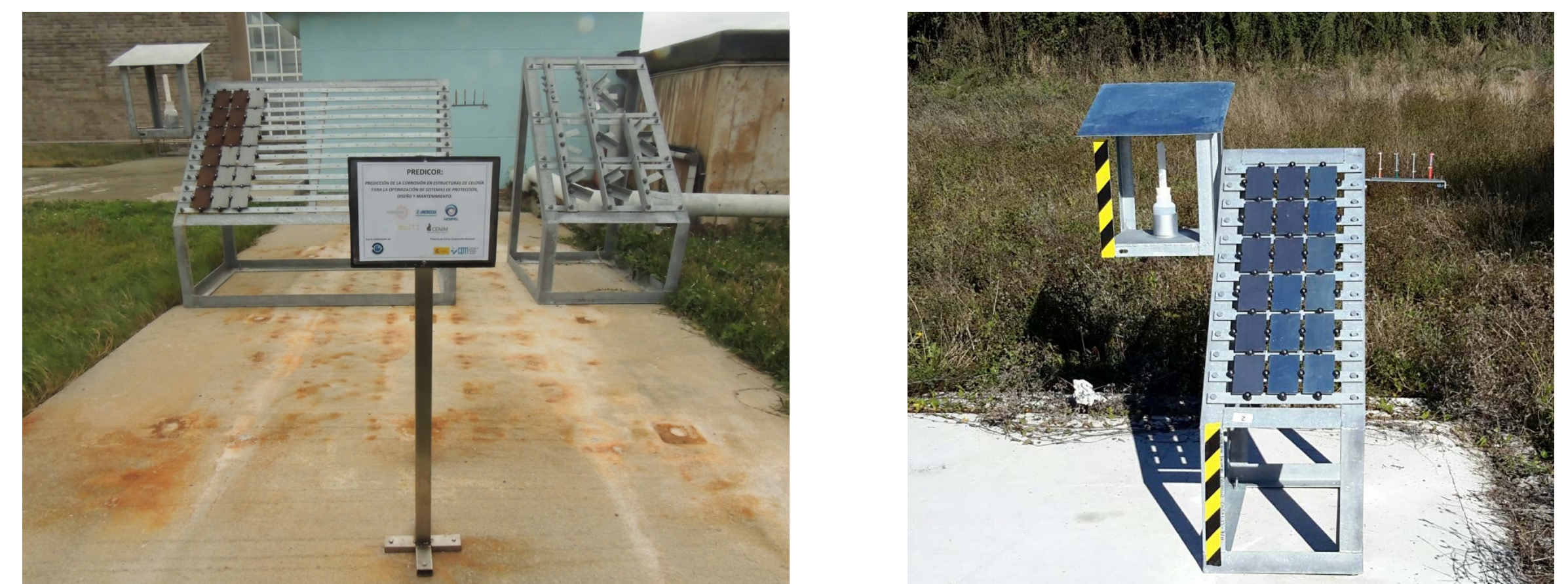
Figura 1. Estaciones de estudio de corrosión
