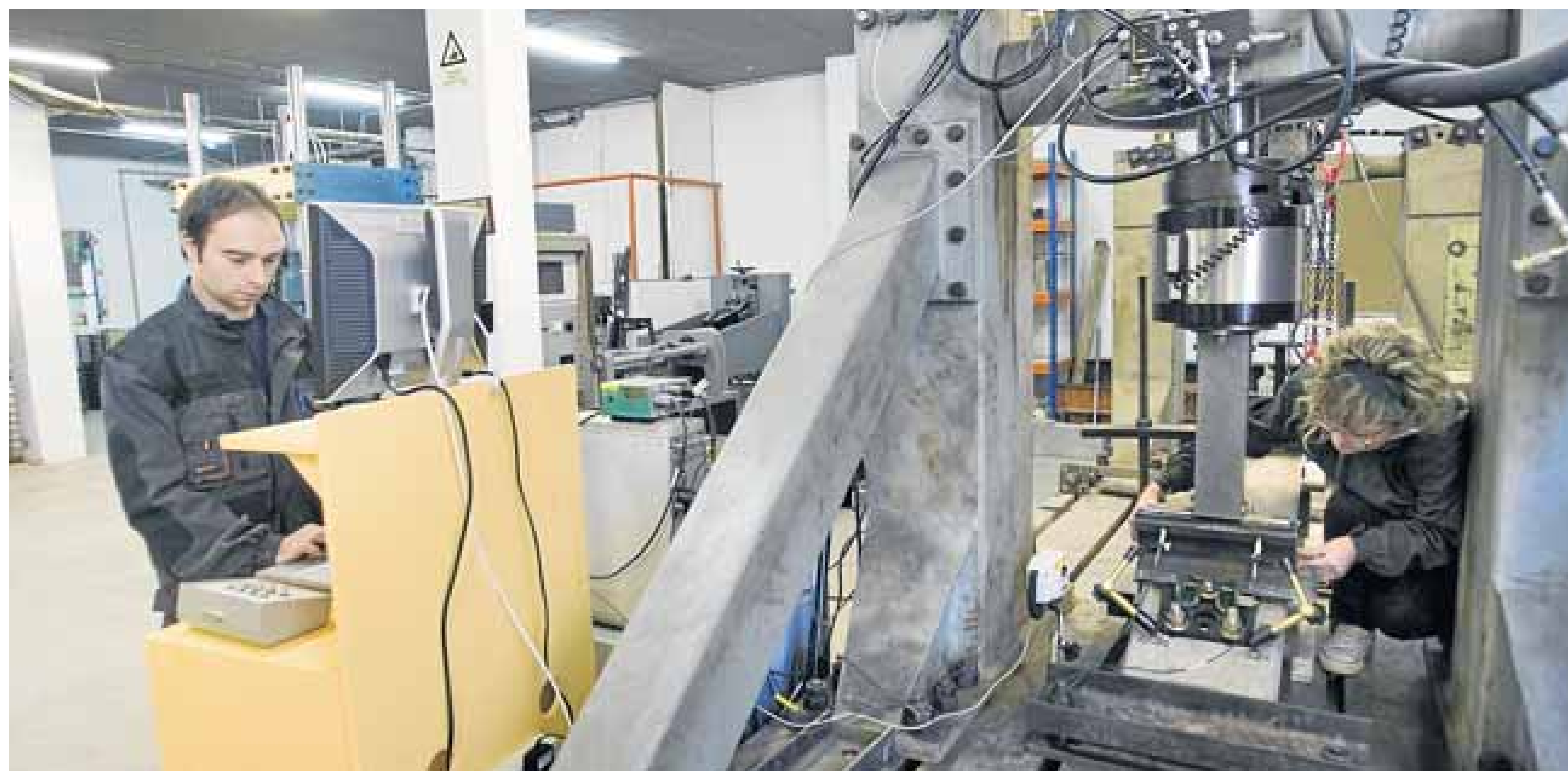
Una de las máquinas de presión que se utilizan en el laboratorio para simular el paso de vagones sobre las vías. :: R. RUIZ
